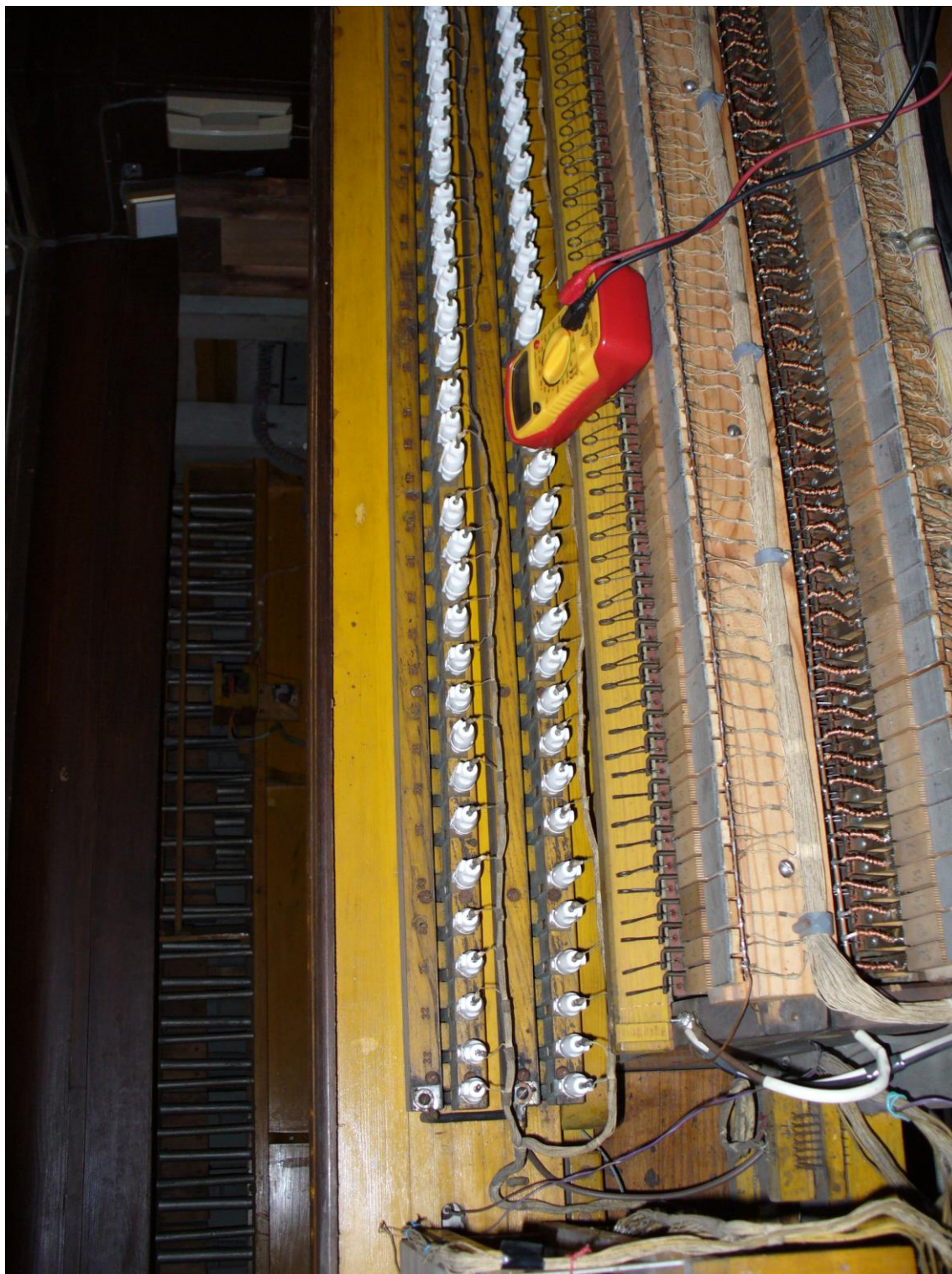
Particolare dei fusibili di protezione dei Registri e della Combinazione Libera Foto 10/15
