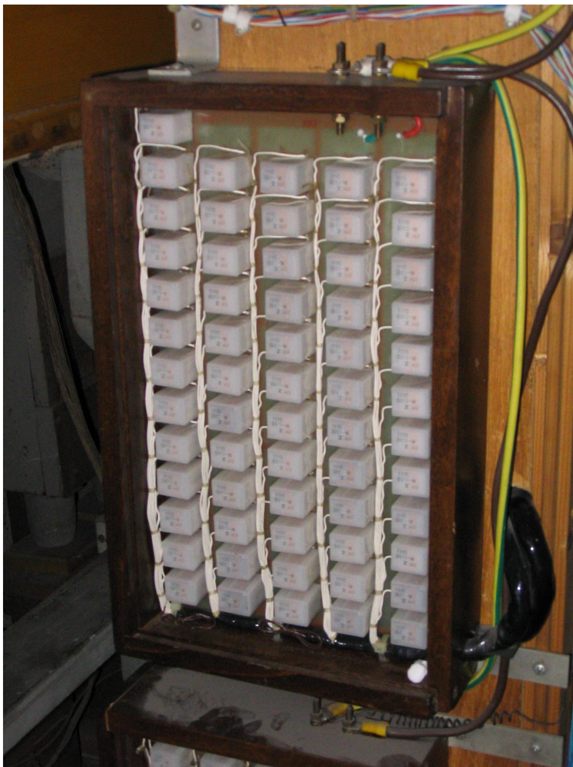
Particolare di una cassetta (aperta) con i microrelé.
